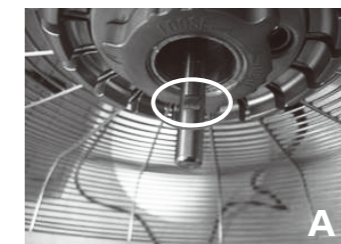
モーターの回転軸(17)の凹み
